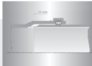
EN CAS D'UTILISATION DES MANCHONS A COLLER, IL CONVIENT DE TENIR COMPTE DE LA DILATATION ET DE LA COMPENSER
